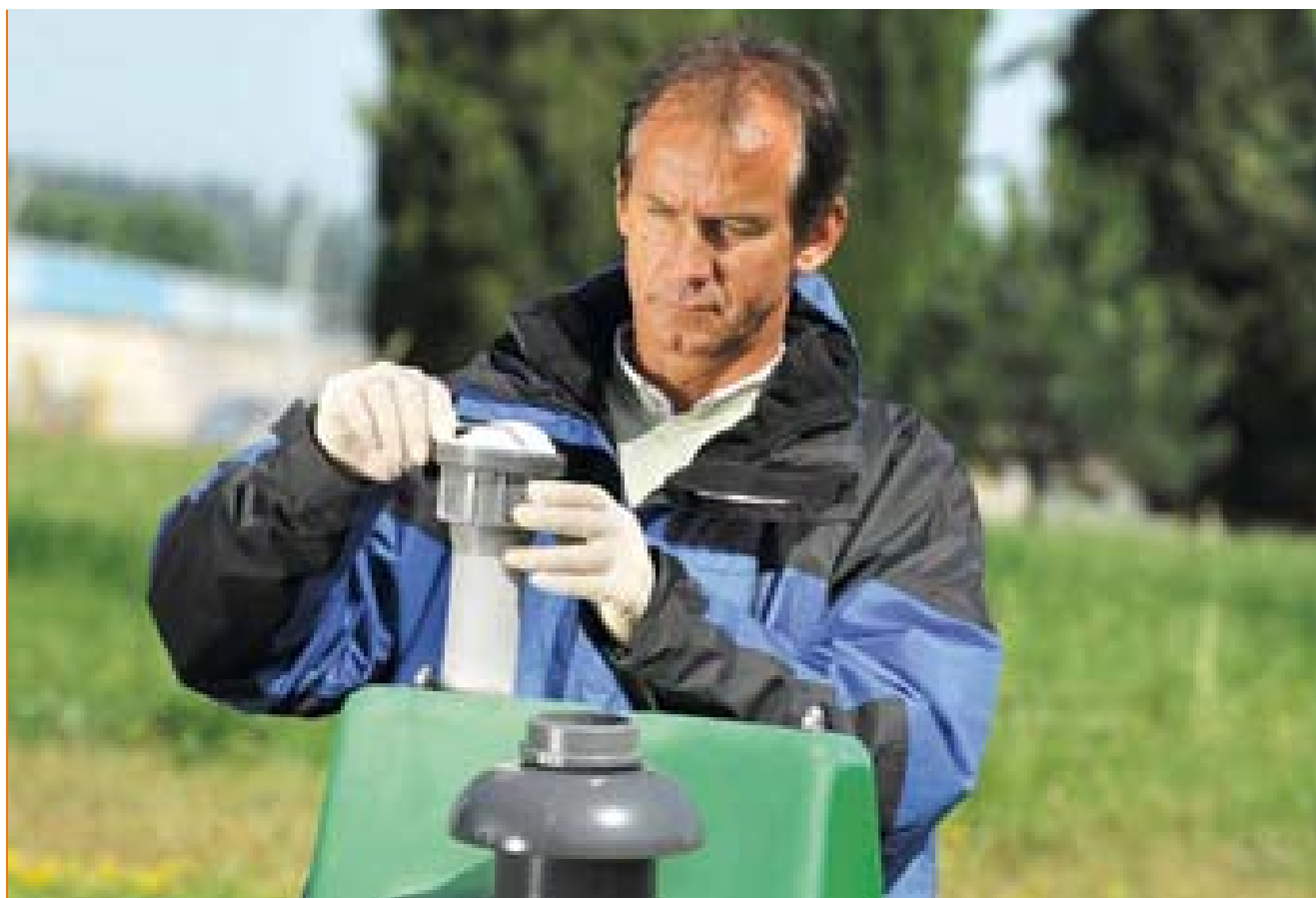
■ Figure V.30 - Récupération du filtre utilisé pour le prélèvement des aérosols atmosphériques sur le site FBFC de Romans-sur-Isère.
