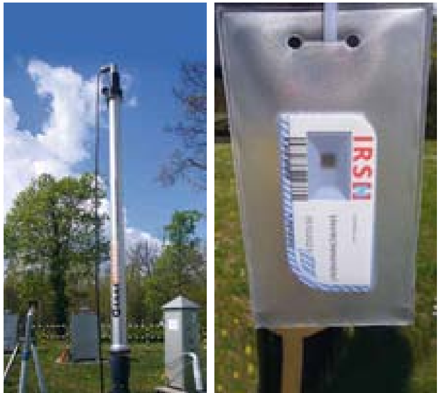
Figure IV.1 - Appareils de mesure du débit d'équivalent de dose gamma de l'atmosphère : à gauche, un équipement actif (sonde Gamma Tracer du réseau EDF), et à droite, un équipement passif (dosimètre de type RPL).
