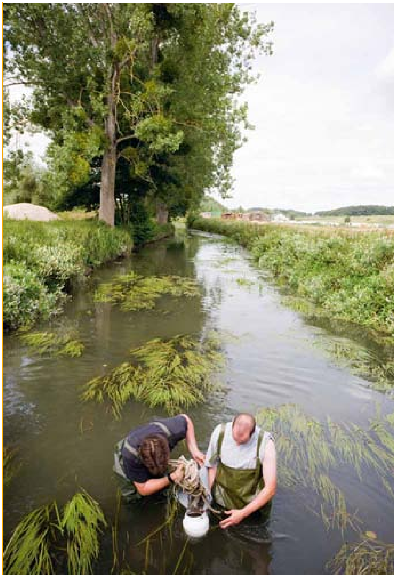
■ Figure IV.78 - Prélèvements de sédiments dans une rivière à l'aide du cône de Berthoulet.
