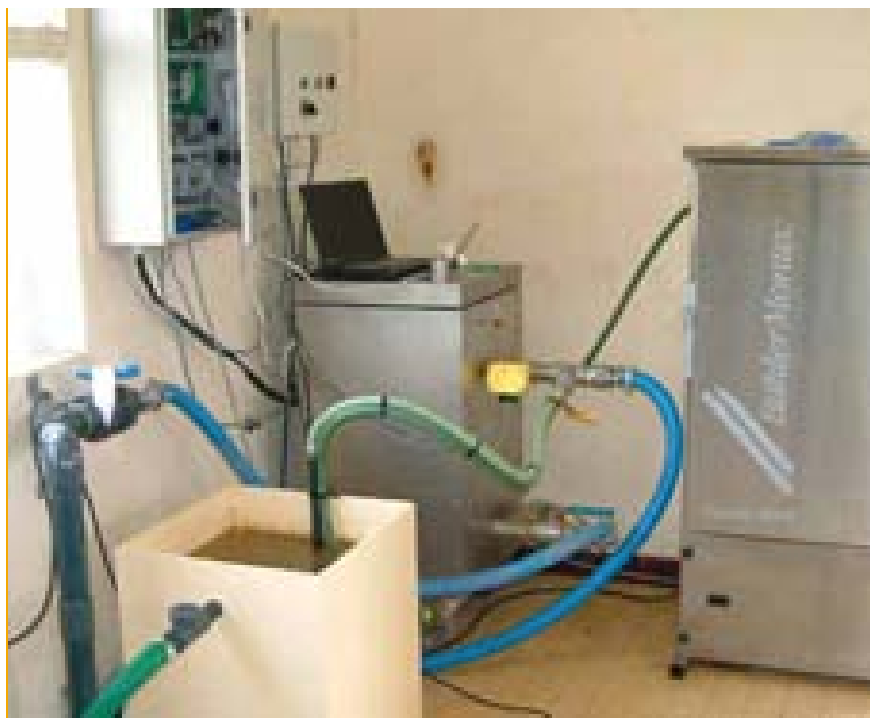
Figure IV.26 - Station Hydrotéléray de Boé (près d'Agen) réalisant la surveillance radiologique en temps réel de l'eau de la Garonne.
