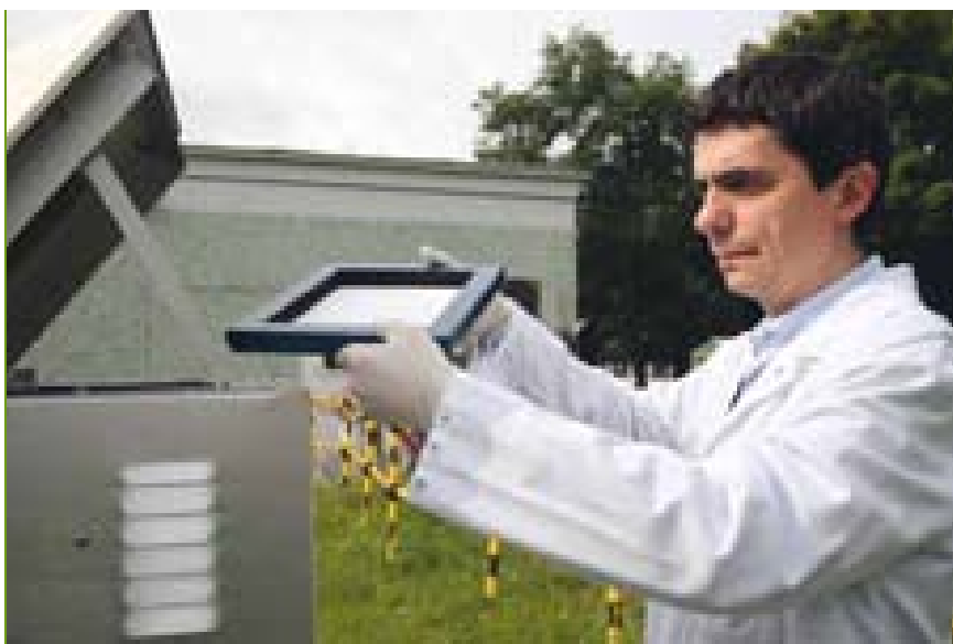
Figure I.8 - Prélèvement d'aérosols atmosphériques sur filtre.
