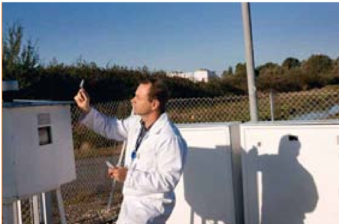
Figure V.70 - Récupération par un technicien EDF d'un prélèvement d'aérosols atmosphériques sur filtre réalisé dans l'environnement proche du CNPE du Blayais.
